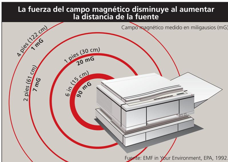
No se puede ver el campo magnético, pero esta ilustración representa la manera en que la intensidad del campo magnético puede disminuir a solamente 30 a 60 centímetros de la fuente. Este campo magnético es un campo de frecuencia industrial de 60 Hz.
