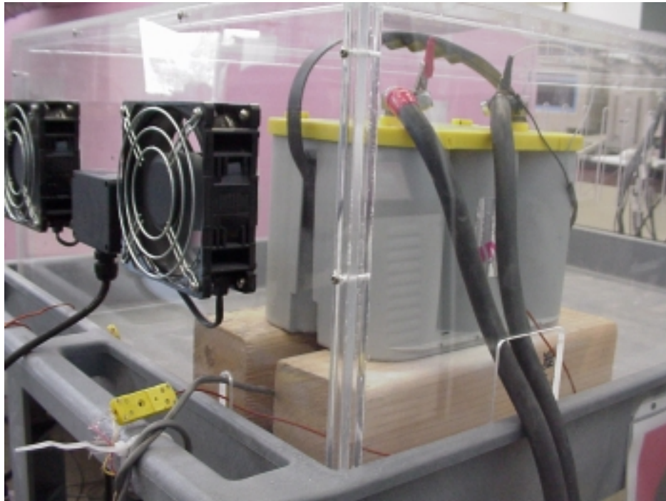
Figure 1 Optima 50 Ah, 12 Volt Module under Cycle Life Test
