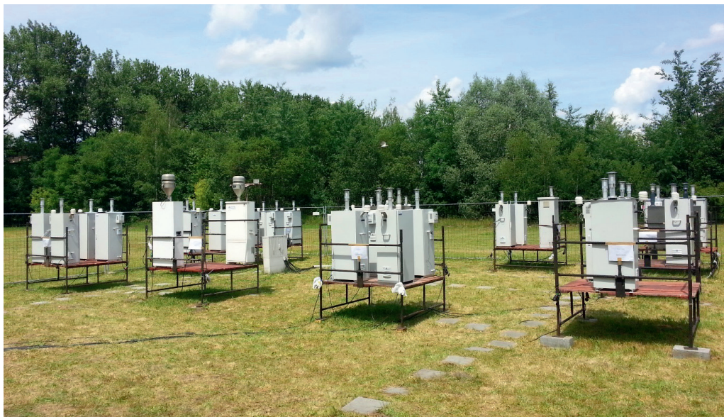
Rysunek 8.2-1. Badania porównawcze dla pomiarów pyłu PM10 i PM2,5 (zdjęcie: A. Pindel).
