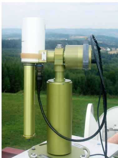
Rysunek 8.4-1. Fotometr słoneczny CIMEL zainstalowany na Stacji Badawczej transferu radiacyjnego SolarAOT w Strzyżowie (zdjęcie K. Markowicz).
