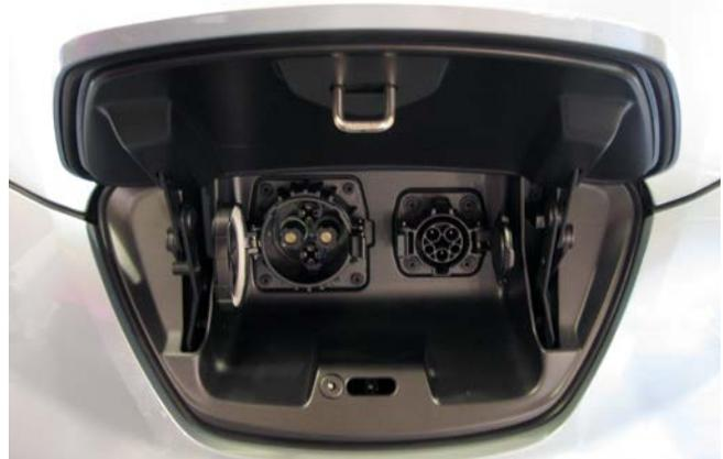
Figura 3. El tomacorriente estándar J1772 (derecha) puede recibir carga de un equipo de Nivel 1 o de Nivel 2. El tomacorriente de carga rápida de DC CHAdeMO (izquierda) utiliza otro tipo de conector. Fotografía de Andrew Hudgins, NREL/PIX 19558
