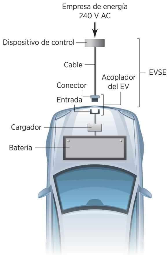
**Figura 1.** Diagrama de carga de Nivel 2. Fuente: eTec (2010), *Pautas de implementación de infraestructura de carga de vehículos eléctricos para las áreas metropolitanas de Portland, Salem, Corvallis y Eugene de la Interestatal 5 en Oregon. Publicación de EV Project, [www.theevproject.com/documents.php](http://www.theevproject.com/documents.php). Ilustración de Dean Armstrong, NREL*
