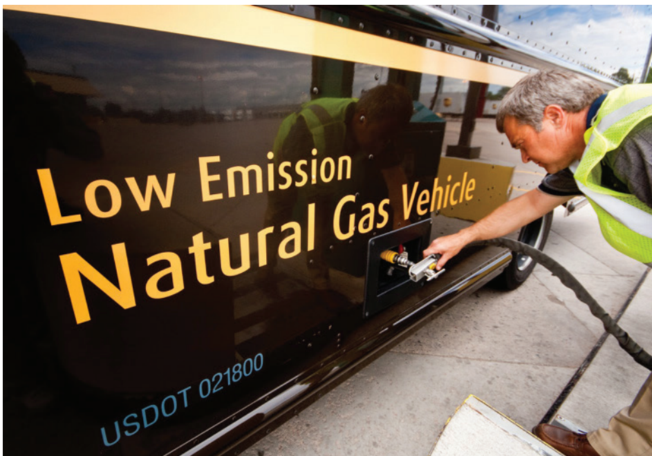
Los vehículos de CNG son alimentados con mangueras de abastecimiento de fácil uso, con cierre a presión. Foto de Pat Corkery, NREL 18188
