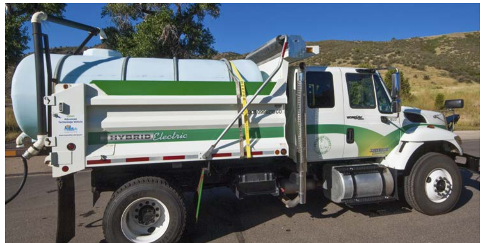
Los HEV funcionan bien para las aplicaciones de carga liviana y las de carga pesada, en particular las que requieren paradas y arranques frecuentes. Fotografía de Pat Corkery, NREL 18142
