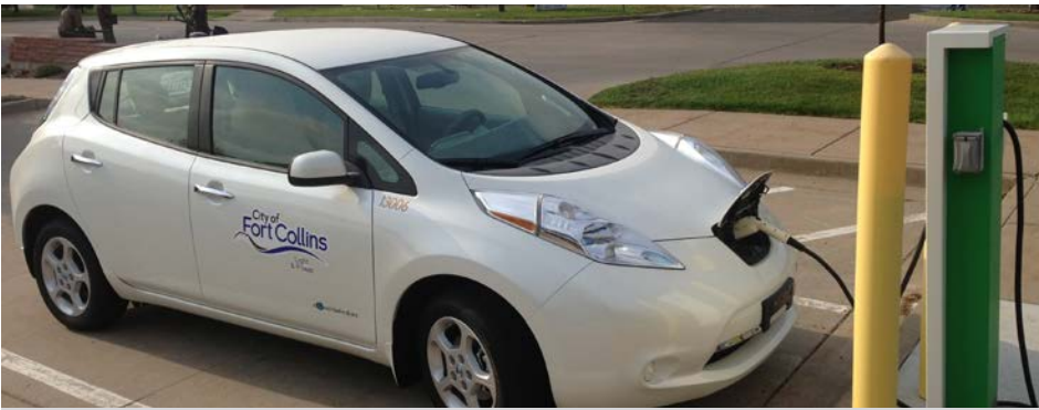
Los EV, que en la actualidad están ampliamente disponibles, deben conectarse para cargarse. Cada vez más flotas de vehículos y consumidores optan por los EV para reducir el uso de petróleo, los costos de combustible y la emisión de gases. Fotografía de la ciudad de Fort Collins, NREL 27238
