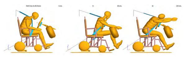
(d) - poor belt fit with no steering-wheel air bag
