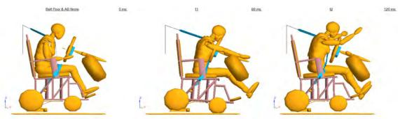
(d) - poor belt fit with no steering-wheel air bag
