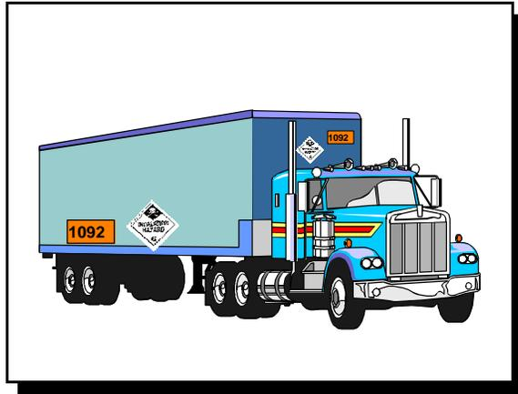
Un vehículo de transporte o un contenedor de carga que contiene 1,000kg (2,205 lbs) o más de peso bruto agregado de un material peligroso, venoso por inhalación en la zona de peligro A o B tiene que estar marcado con el número de identificación requerido en la Sección 172.313 y 172.332.
