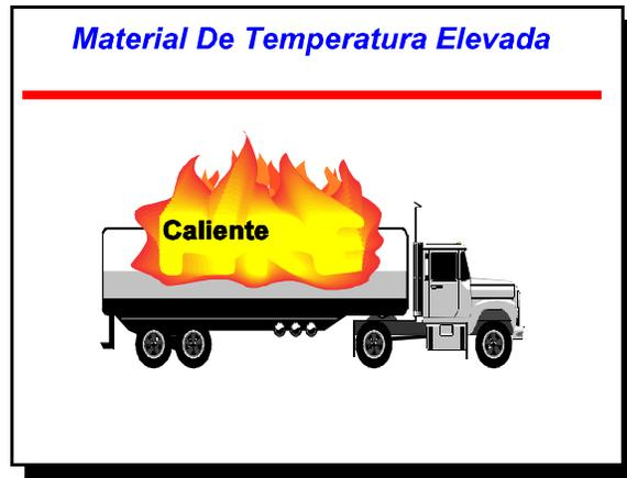
Envases a granel que contengan material de Temperatura Elevada tiene que ser marcados en dos lados "HOT" (CALIENTE). "Molten Aluminum" (Aluminio Derretido) y "Molten Sulfur" (Azufre Derretido) tienen que ser marcados "MOLTEN ALUMINUM" o "MOLTEN SULFUR" como apropiado.
