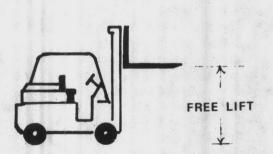
D. FREE LIFT IS THE DISTANCE THE FORKS MAY BE RAISED BEFORE THE COLLAPSED MAST HEIGHT IS INCREASED.
