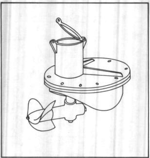
FIGURE 121 Propeller Meter
