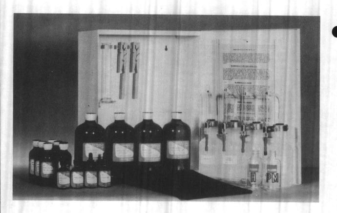
FIGURE 97 **Jar Test Reagent Kit**
