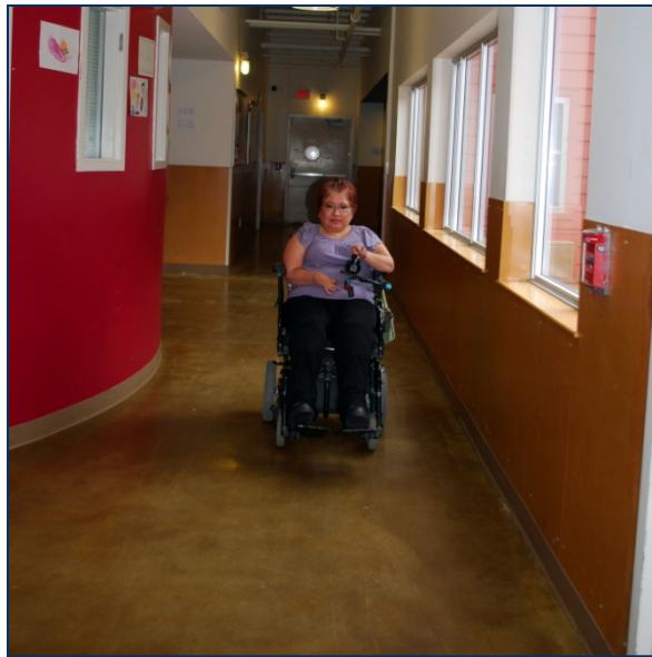
Pasillo amplio con espacio para girar en el refugio de emergencia
