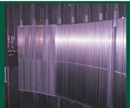
Fig. E11. Detector array for the CNCS instrument.
