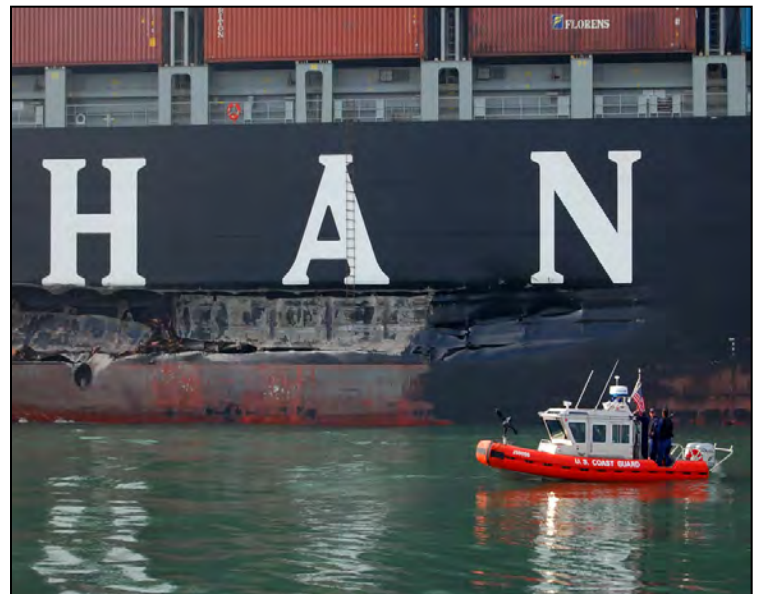
Agujero en el barco de contenedores Cosco Busan que derramó 53,000 galones de petróleo en la Bahía de San Francisco en el 2007.
