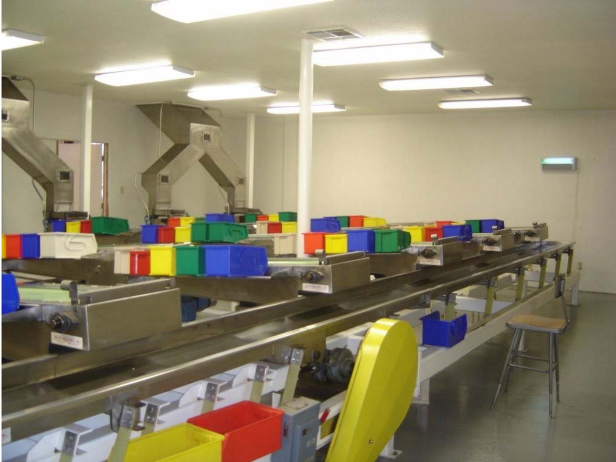
این اتاق در یک کارخانهء پروسس بادام مثالی از روش های خوب تولیدی میباشد. دیوارها، فرش ها و سامان آلات از موادی ساخته شده که به آسانی شسته و بهداشتی میشود. به تنویر فراوان نیز توجه شود. به حشره کش های برقی نصب شده بروی دیوار ها نیز توجه کنید.
