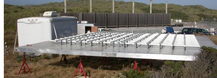
1/4-scale 449-megahertz profiler
