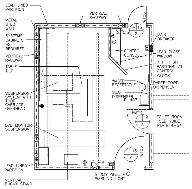
SEE ALSO PG-18-4, SD 13 49 00-3 LAYOUT AND NCS SD 13 49 00-4 FOR RACEWAY LAYOUT FOR DOD/VA UNIVERSAL X-RAY ROOM
