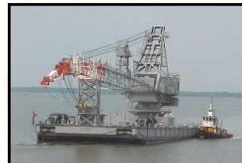
Barge Derrick Crane (BD 115)
