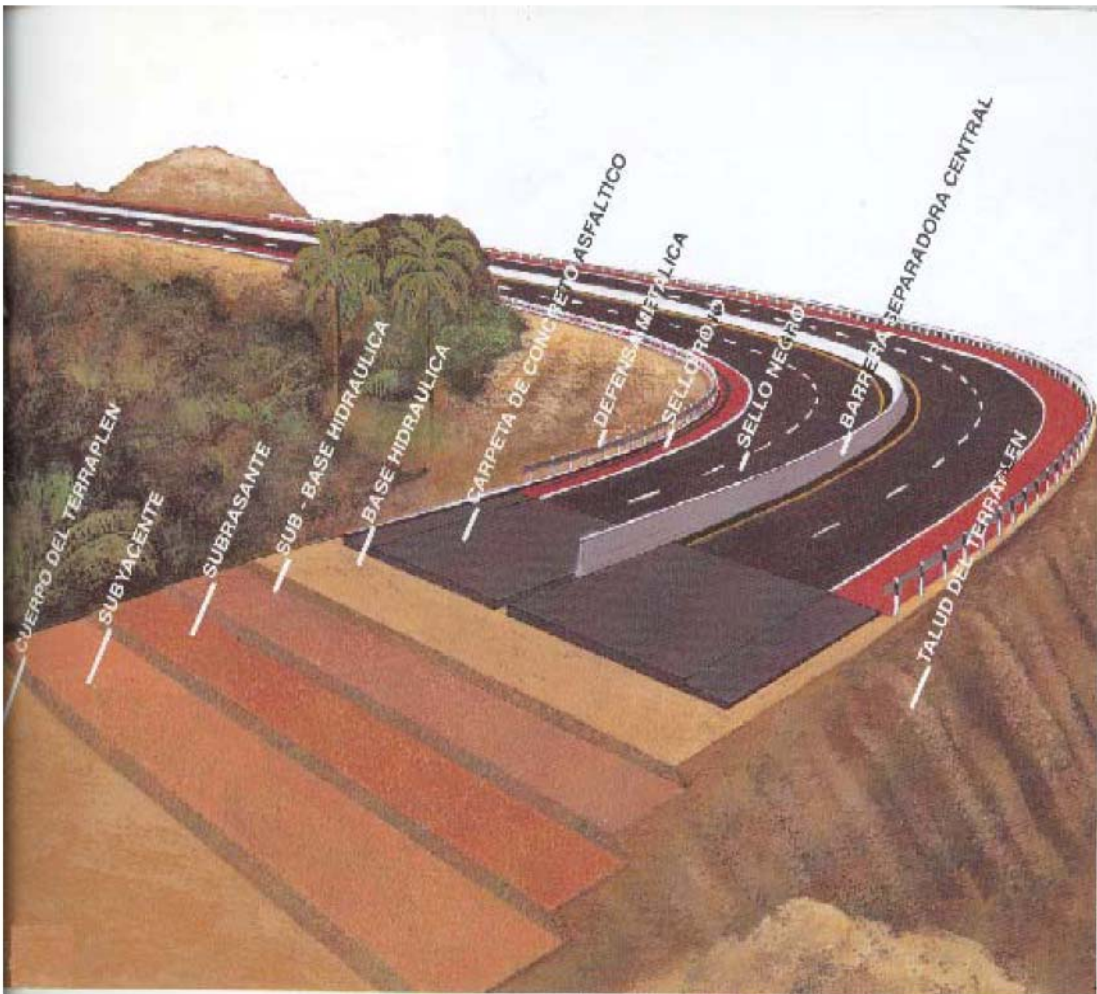
Sección típica de un terraplén
