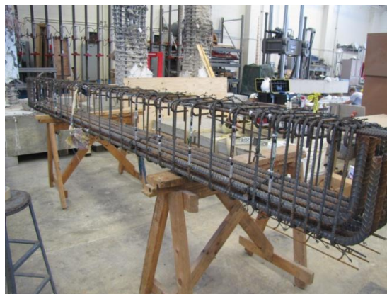
(d) Beams with stirrups in test region
