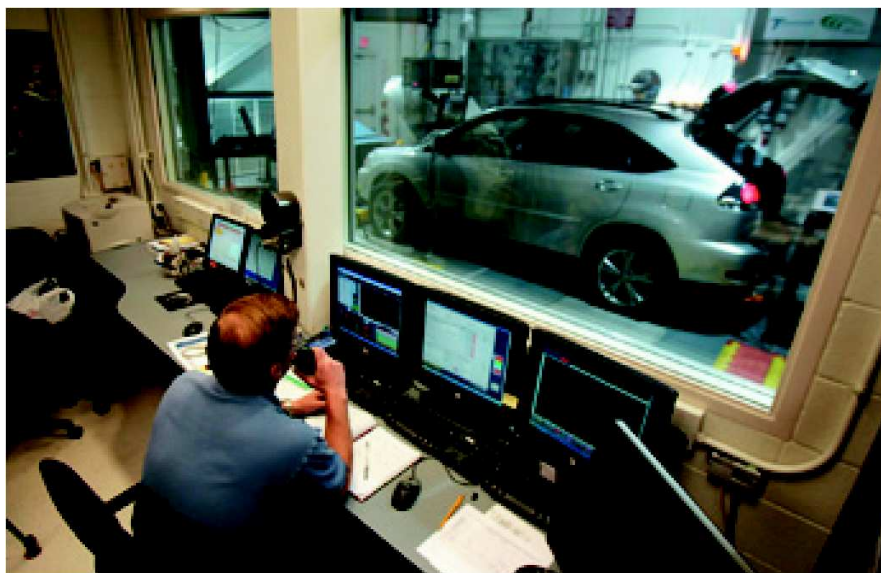
Pesquisador observa teste com carro híbrido Lexus no Laboratório Nacional Argonne
