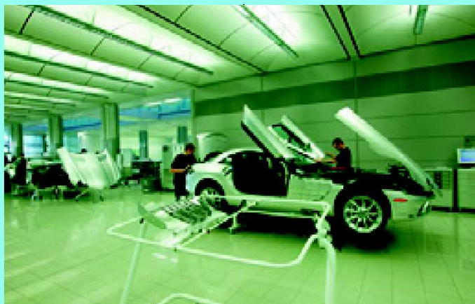
Compostos de fibras de carbono são usados para fazer portas, capota e carroçaria para o Mercedes-Benz SLR McLaren em montadora da Inglaterra
