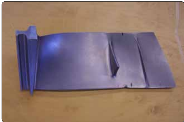
Figure 10-59. Fan blade damage.
