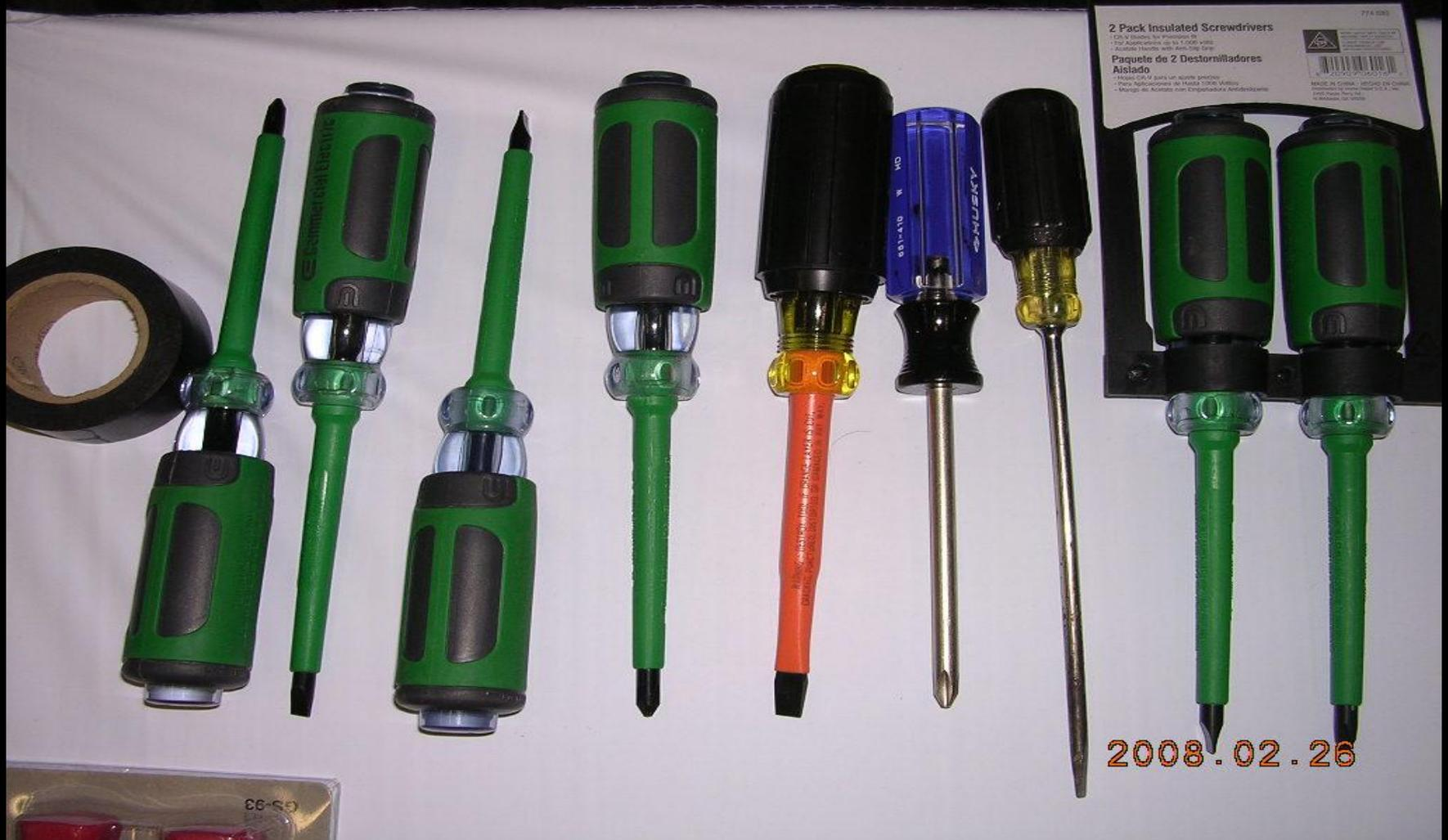
Se deben utilizar herramientas recubiertas con material aislante, para proteger a los trabajadores de los circuitos energizados
