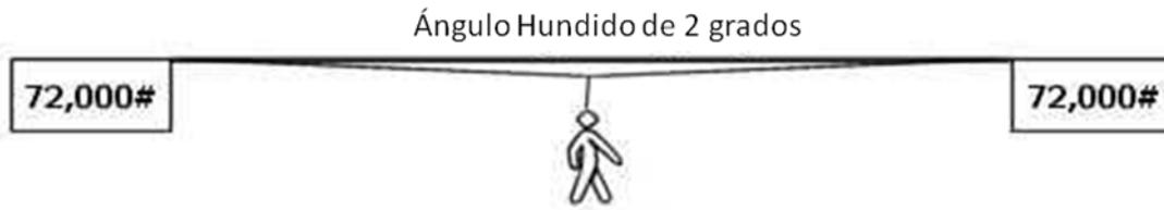
El Anclaje de la Carga Varía con el Ángulo Hundido de la Línea Horizontal
