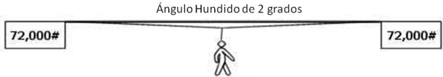
El Anclaje de la Carga Varía con el Ángulo Hundido de la Línea Horizontal
