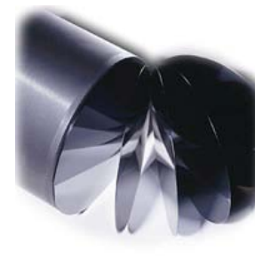
c-Si \sim 180 \mu\text{m}
