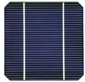
c-Si \sim 180 \mu\text{m}
