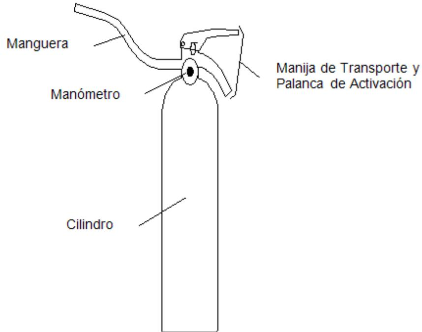
**Componentes de un extinguidor portátil: Manguera, manija de transporte y palanca de activación, y cilindro**
