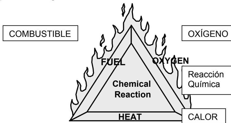
Triángulo del Fuego: El combustible, el oxígeno y el calor crean una reacción química que causa el fuego.
