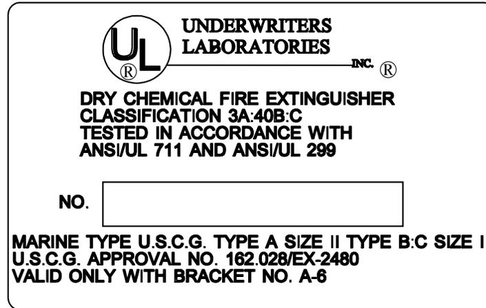
Muestra de una etiqueta del fabricante de extinguidores, donde aparece en la parte de arriba el logotipo de Underwriters Laboratories, el tipo y clasificación del extinguidor, los procedimientos de prueba usados y el número de serie. En la parte de abajo de la etiqueta está la información marina, incluyendo el número de aprobación de la Guardia Costera de EE.UU.
