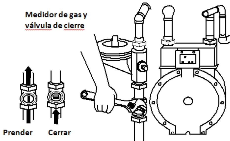
El diagrama del medidor de gas muestra la ubicación de la válvula de cierre en la tubería que sale del suelo. Para cerrar la válvula, use una llave inglesa que no haga chispas para dar vuelta a la válvula un cuarto de giro, en el sentido de las manecillas del reloj. Recuerde que, en todos los casos, el flujo de gas natural sólo puede ser abierto por un técnico autorizado.
