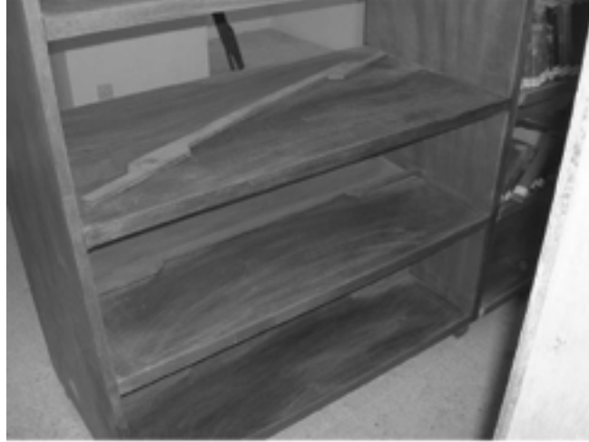
الصورة ٧ - رفوف مصنوعة من خشب مضغوط بدلاً من الخشب الصلب
