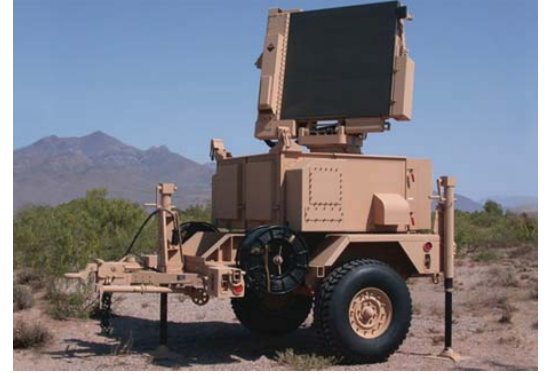
رادار الدفاع الجوي لنظام الصواريخ الانتقامية السريعة والذي يعمل تلقائياً على كشف وتعقب، وتحديد، وتصنيف، وإصدار التقارير بشأن التهديدات الجوية. (صورة من طاليس/رايونيون).
