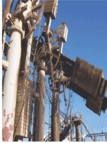
صدأ وتآكل في ذراع التحميل في المرسى 1 مع تسرب نפט منها
