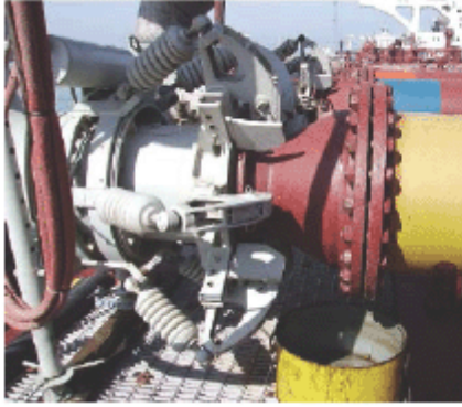
وصل ذراع التحميل بناقلة النפט تتلقى النפט
