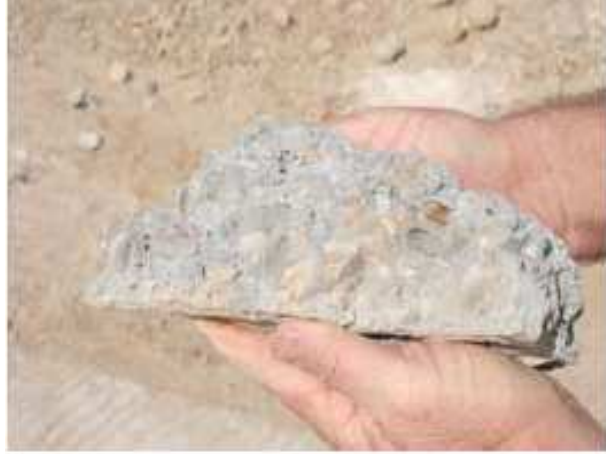
صورة الموقع 10 – قطعة خرسانة هشة وسهلة التفتت النقطت من الطريق باليد
