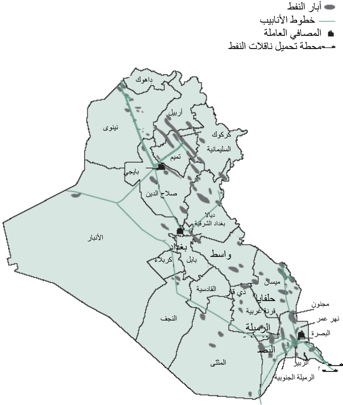
الشكل ٢-٢١ البنية التحتية للغاز والنفط حسب المحافظات المصدر: خريطة البلاد لووكالة الاستخبارات المركزية (CIA)
