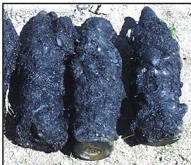
Un proyectil de calibre de 5 pulgadas limpio (izquierda) y proyectiles calibre 38 de 5 pulgadas recobrados (derecha).
