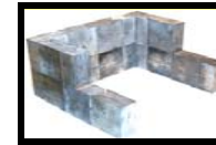
LADRILLOS DE PLOMO CONTAMINADOS
