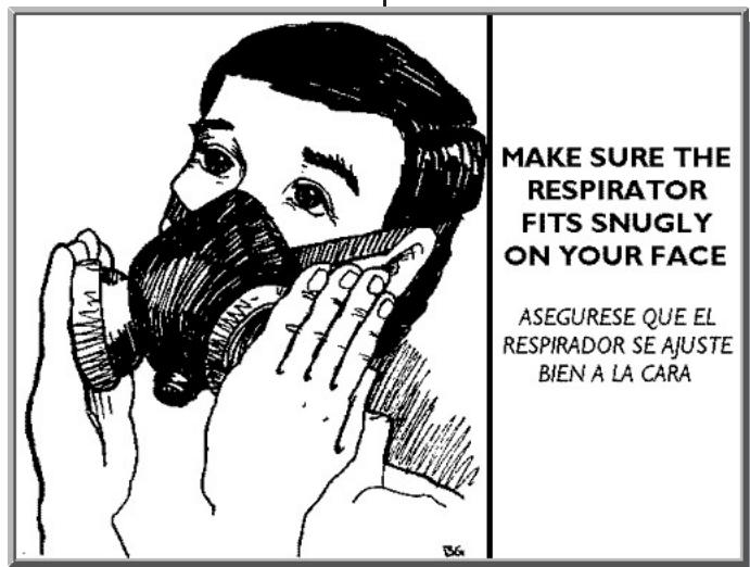
Un respirador es una de las piezas más importantes de equipo para los aplicadores. Los respiradores de cartuchos químicos tienen uno o dos cartuchos adjuntos a la pieza de la cara. Este tipo está equipado generalmente con válvulas de una-dirección que permiten que el aire inhalado pase a través de los cartuchos. Si el respirador usa filtros, los filtros se tienen que cambiar diariamente. Pregúntele a su supervisor si tiene dudas sobre el uso de un respirador.
