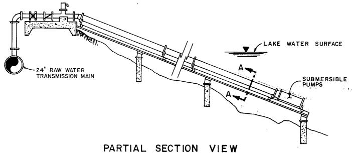
SUBMERSIBLE PUMPS IN SLIDE & TROLLEY CONFIGURATION
