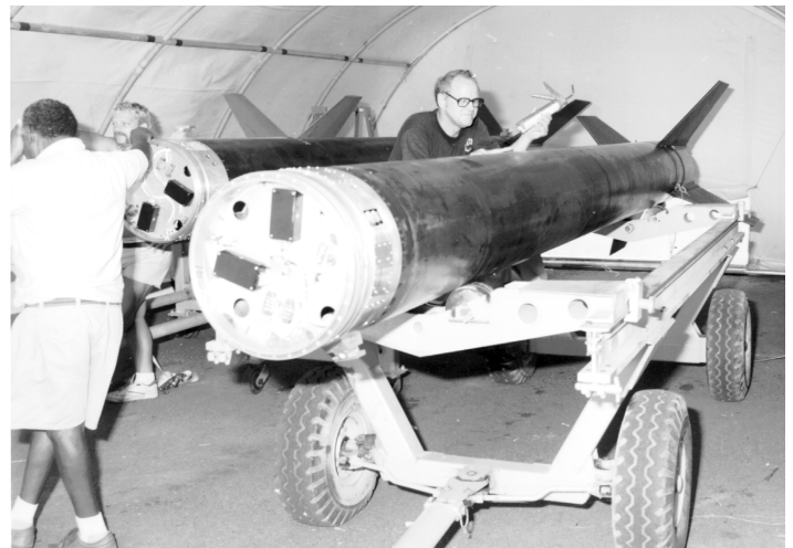
Un motor "Black Brant V" de un cohete suborbital es preparado para lanzarse durante la Campaña El Coquí de 1992. La mayoría de los lanzamientos durante Coquí Dos utilizarán el "Black Brant V" de una etapa.
