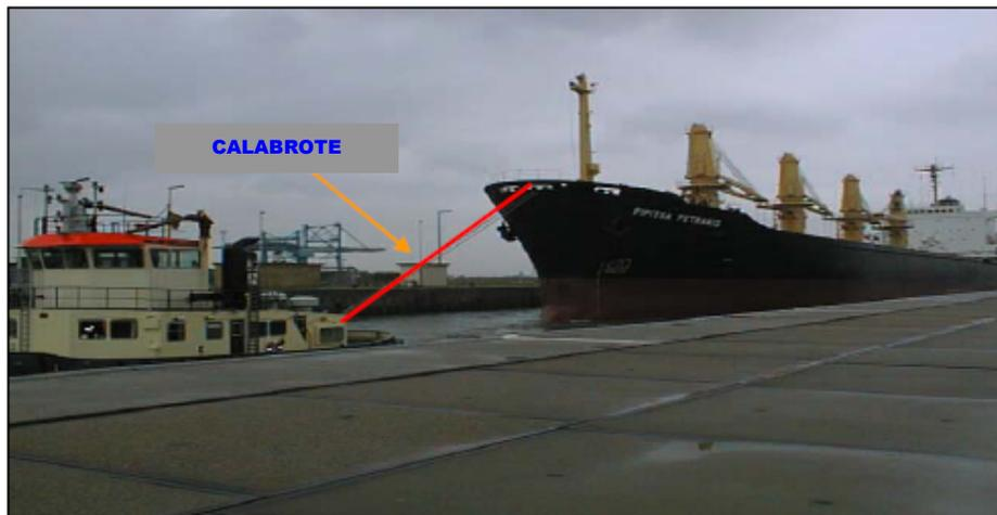
Figura 2-4. Remolcador de proa utilizando un calabrote por la gatera central.
