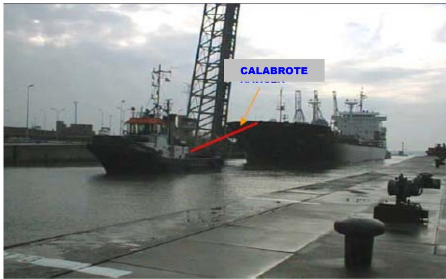
Figura 2-5. Remolcador de popa utilizando un calabrote por la gatera central.
