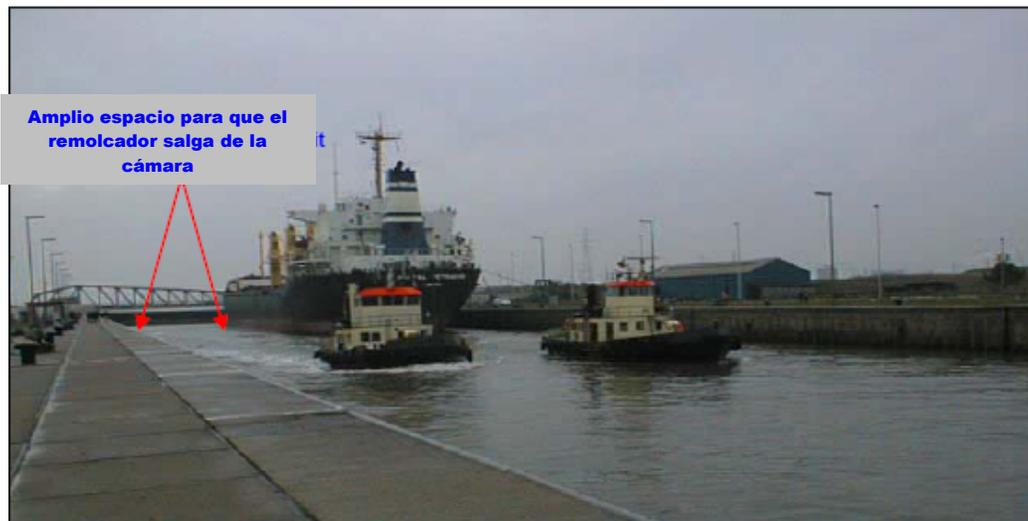
**Figura 2-7. Remolcador de proa saliendo de la cámara después de terminar la maniobra de atraque.**
