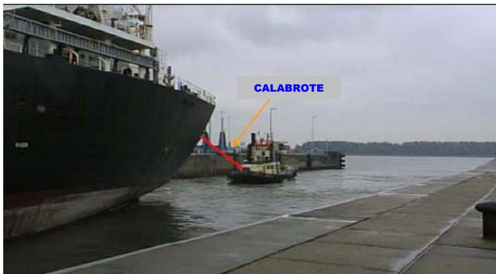
Figura 2-6. Remolcador de popa utilizando un calabrote a través de la gatera central.
