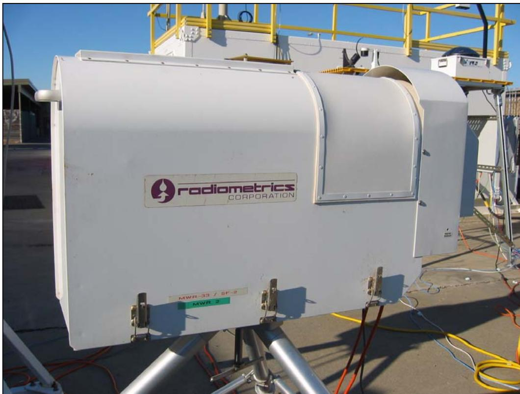
MWR 测量水蒸气和液体水柱状综合量的时间序列。水蒸气只是空气中的水分子，您可以看得见。液体水是云中的水滴。MWR 报告的水蒸气值就是如果您将雨量计上方所有的水都凝析成液体水，那么您将在雨量计中得到多少水。虽然云似乎含有大量的水，但 MWR 测得的液体水值通常只是十分之几毫米。MWR 不能探测冰。高度超过 5 公里 (km) 的云通常由冰粒而不是由水滴组成，所以 MWR 不能探测。
