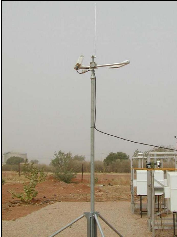
目前天气探测仪 (PWD) 通过估算降水中的水含量加上光学向前散射和温度来测量近地面的能见度。AMF 装有 Vaisala PWD22。根据天气条件，该 PWD 可测量远达 20 公里的能见度。
