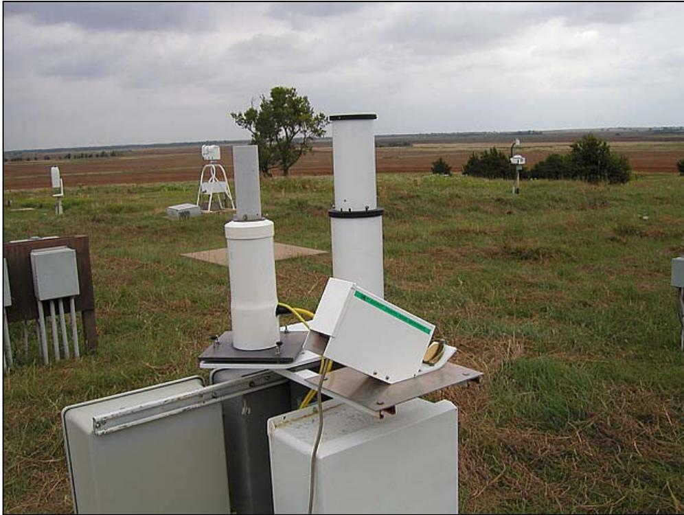
双频道窄视场天顶辐射计 (2NFOV) 是以地面为基础的辐射计，直指天空。2NFOV 通过其窄视场以 1 秒的时间序列来测量天顶向下辐射。辐射的测量波长是 869 纳米。举例来说，该仪器所收集数据的用处之一是研究云的内部结构。
