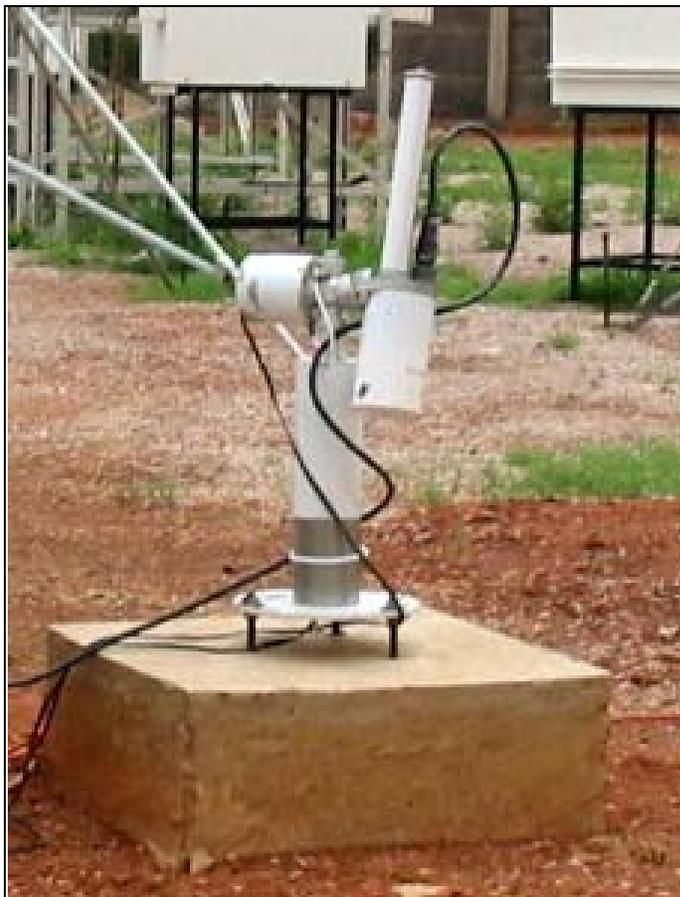
Cimel 光度计 (CIMEL) 是一台多过滤器自动太阳追踪辐射计，测量气溶胶、水蒸气和臭氧，以及直接太阳辐射和地球表面的反射天空辐射。测量以事先确定的任意波长在光谱的可见和近红外范围内进行，以确定大气传送和散射特性。CIMEL 只能在白昼（即太阳在地平线以上时）作业。
