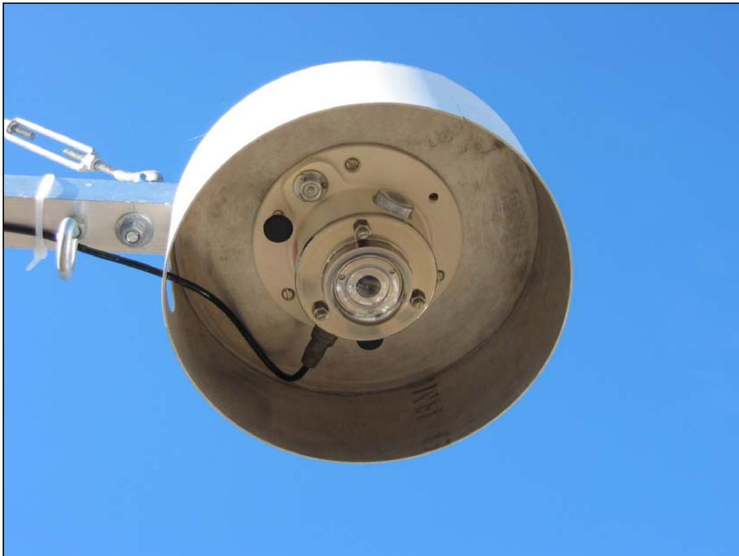
PSP 测量透明穹顶下传感器所接受的太阳辐射（日光）量。当 PSP 俯视时，它测量的是下方地表反射的太阳辐射量。该值取决射到地面的日光量以及地面反射日光的性能。
