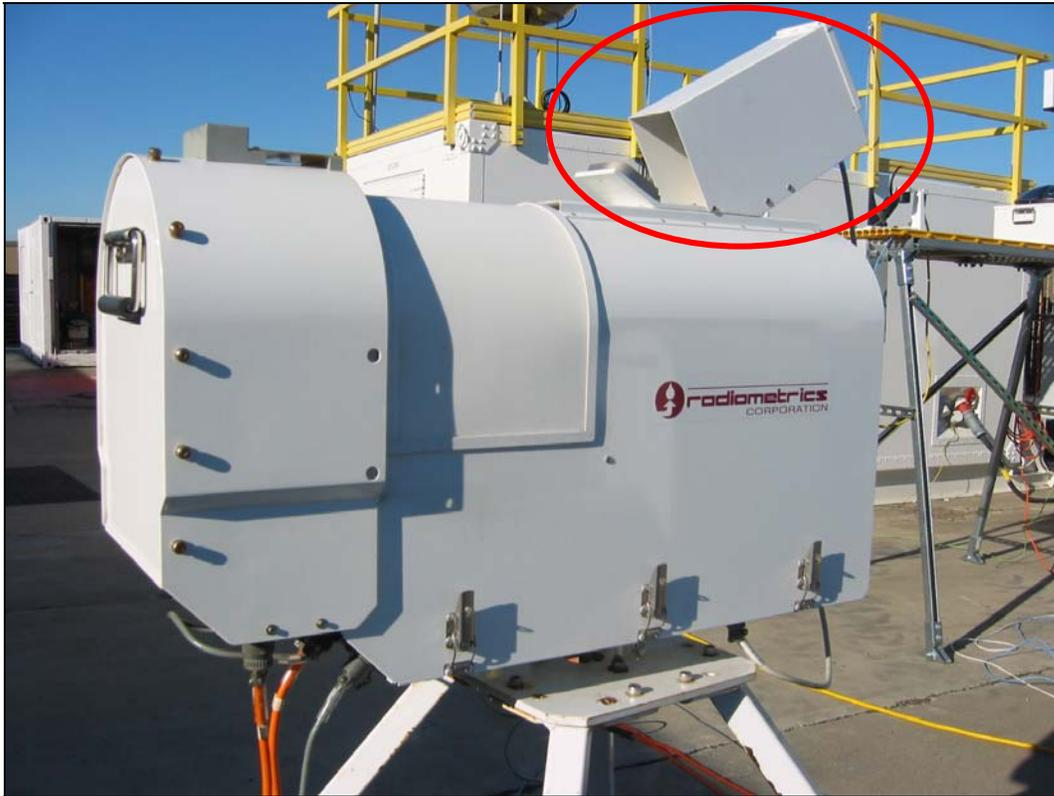
MWRP 提供高达 10 公里的水蒸气、液体水和温度的连续剖面。这些剖面在晴朗、多云和降水的情况下以每 10 秒的间隔获得。温度用装在顶部的红外温度计 (IRT) 测量。
