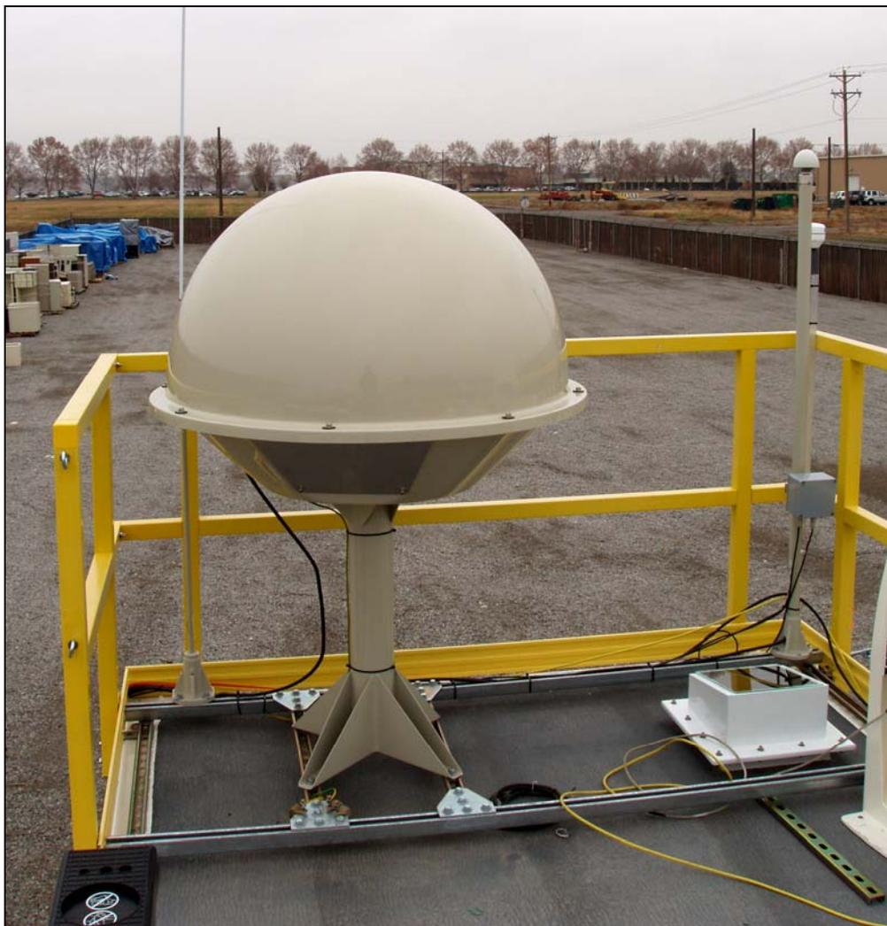
气球运载探测系统提供大气热动力状态（即温度）和风速及风向的垂直剖面。数据由装在天气气球上的无线电探测仪收集。BBSS 的主要部件是无线电探测仪、接收数据的天线（见上图）以及从无线电探测仪收集数据的 DigiCORA 计算机软件。
