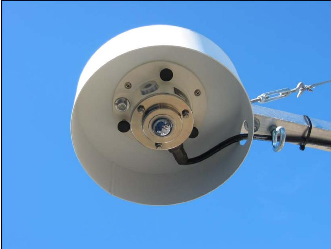
PIR 测量光亮穹顶下传感器所接受的红外（热）能量。该能量和您站在篝火或炊炉边所感受到的热能是一样的。光亮的穹顶反射太阳辐射，但却让红外辐射通过。当 PIR 俯视时，它所测量的是下方地面向上发出的红外辐射量或热能。
