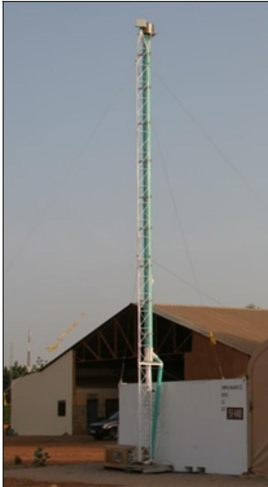
AOS 在地面进行原地气溶胶测量。主要测量的是与颗粒度及与辐射波长有关的气溶胶吸收和散射系数。其它测量内容包括颗粒数浓度、颗粒大小分布、湿性生长及无机化学成分。AOS 测量气溶胶的光学特性，以更好地了解颗粒如何与太阳辐射相互作用并影响地球的辐射均衡。
