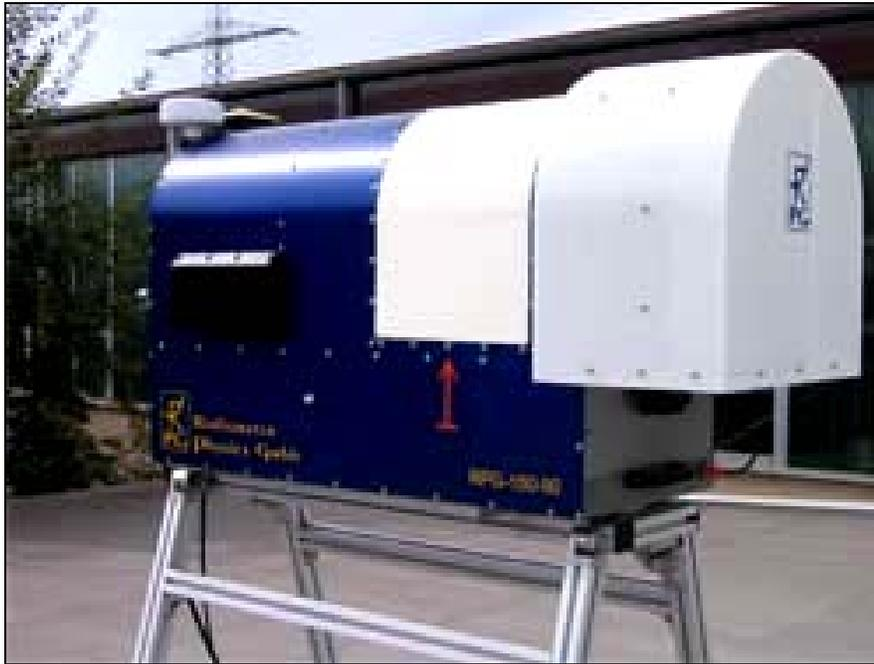
微波辐射计 – 高频 (MWRHF) 提供来自以 90 和 150 GHz 为中心的两个频道的亮度温度测量。这两个频道对液体水和可降水蒸气非常敏感。
