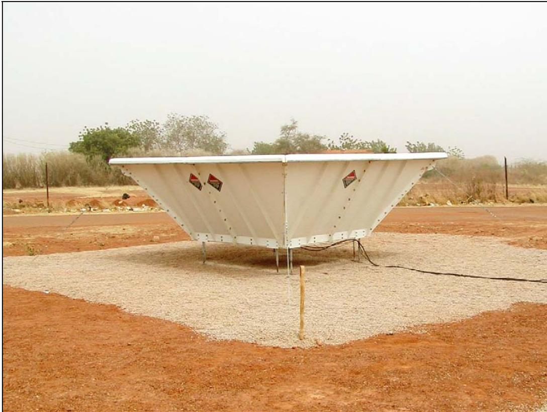
RWP 通过将电磁能传送到大气中并测量返回散射能量的强度和频率来测定 2 至 5 公里的风剖面 and 从 1 至 2 公里的虚拟温度剖面。
