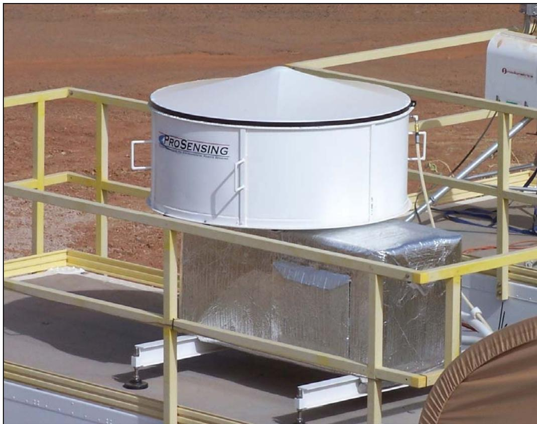
W 频带 ARM 云雷达是一套指向天顶的雷达，以 95 GHz 的频率运行。该雷达的主要目标是确定云的边界（即云底和云顶）。该雷达还可以报告 20 公里范围内大气的雷达反射性 (dBZ)。此外，WACR 还具有多普勒能力，可以测量云成分的垂直速度。
