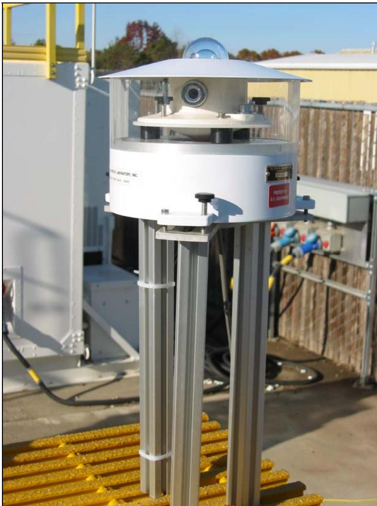
PSP 测量透明穹顶下传感器所接受的太阳辐射（日光）量。当无遮荫对向上方时，PSP 测量测量的是来自太阳的直接辐射加上由云、空气中其他材料及空气本身向下散射的辐射总量。该值被称为“总”或“全球”太阳辐射。有云时，该值降低。
