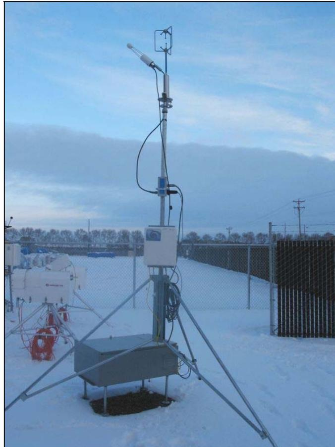
埃迪校正通量测量系统提供动量、显热和隐热地面垂直通量的原地半小时平均值。这些通量值由埃迪校正技术，即通过校正垂直风和水平风成分、太阳温度（约等于虚拟温度）和水蒸气密度获得。用一台三维声学风速仪取得正交风成分和声波温度。用红外湿度计取得水蒸气密度。
