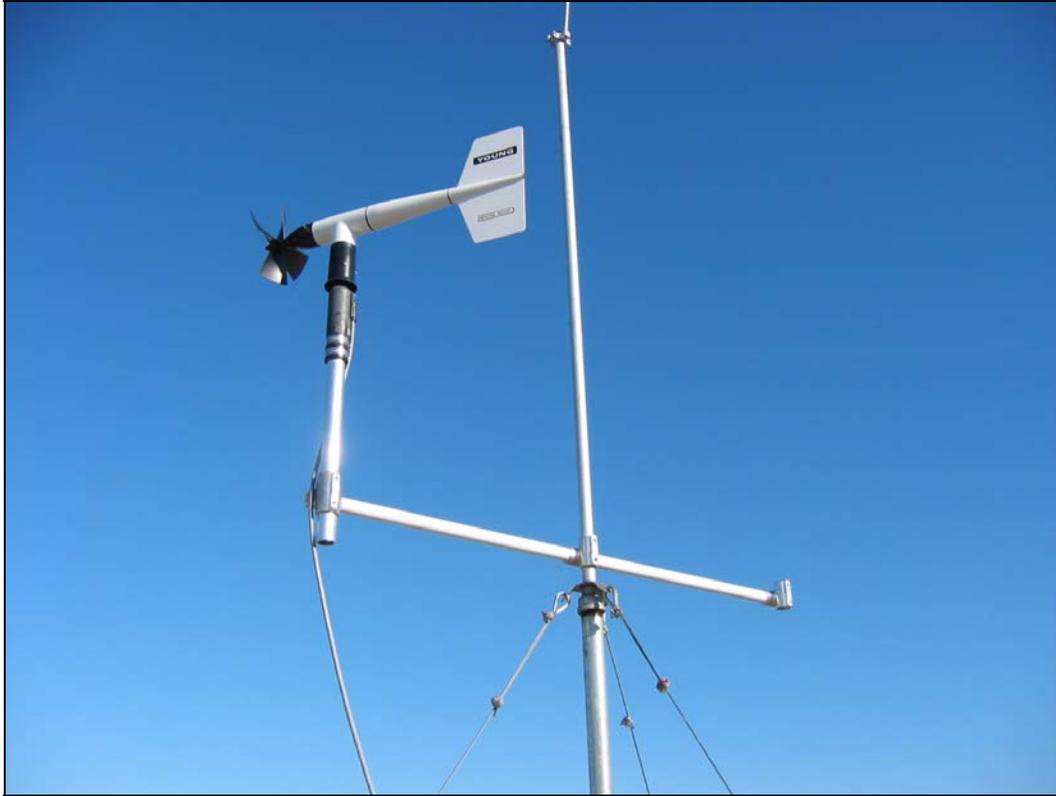
该风传感器安装在气象测量塔顶部。螺旋桨叶片测量风速。风向根据叶片的位置来测量。
