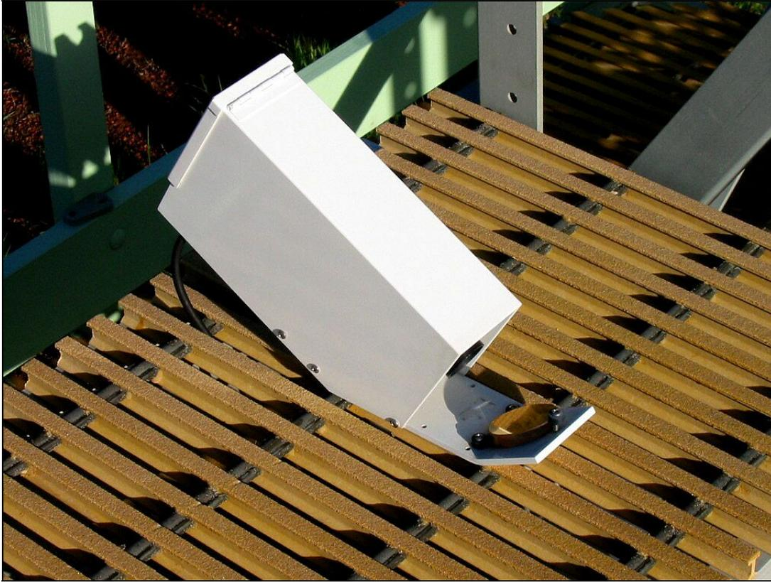
IRT 测量其对准的一个物体的温度，计算来自该物体的红外辐射量。如果您将其对着炊火，它将告诉您炊火的温度。当 IRT 对着上方的时候，它测量的是大气的辐射温度，也称为“天空温度”。当云层低的时候 IRT 测量云底面（或基面）的温度。低云层的基面温度可能是 $+10^{\circ}\text{C}$ 。当云层较高时，IRT 测量的是大气与高云层的综合辐射温度。
