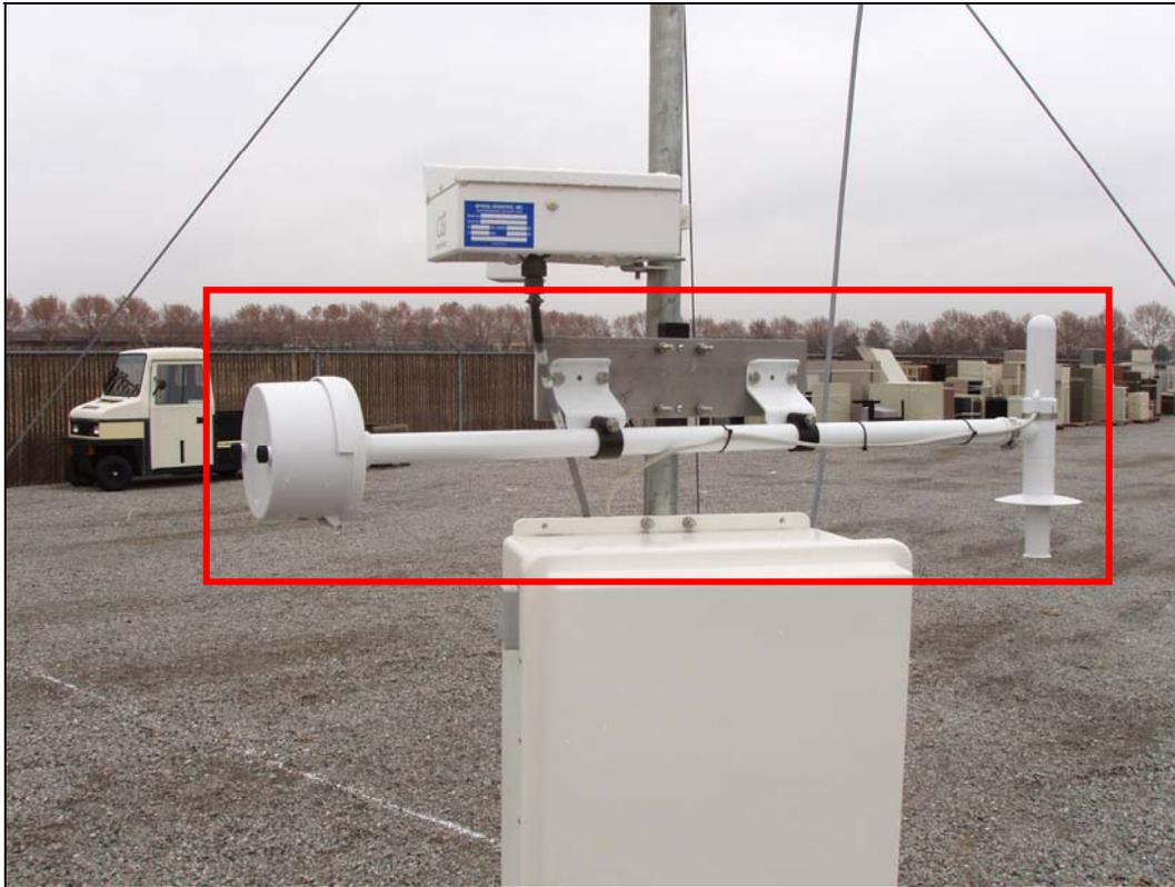
温度和湿度传感器安装在一个圆管内以保护其不受日光直接照射。圆管安装在气象测量塔近底部。一端有一个小风扇将空气打入圆管，经过传感器。
