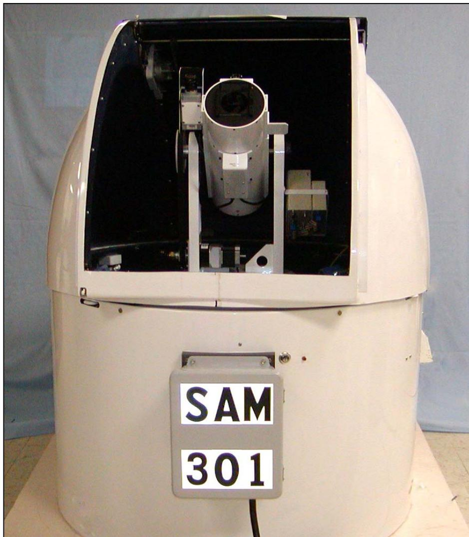
太阳和气溶胶测量 (SAM) 系统提供以地面为基础的对日轮辐射剖面及有关日晕的测量。日晕由太阳辐射通过大气气溶胶和云而生成。日轮辐射测量云的光学深度，而日晕测量则提供日光前进散射的信息。日光前进散射则取决于沿视线分布云的冰/水成分。日晕剖面对了解云的传送效应以及卷状云的颗粒大小和含冰量至关重要。
