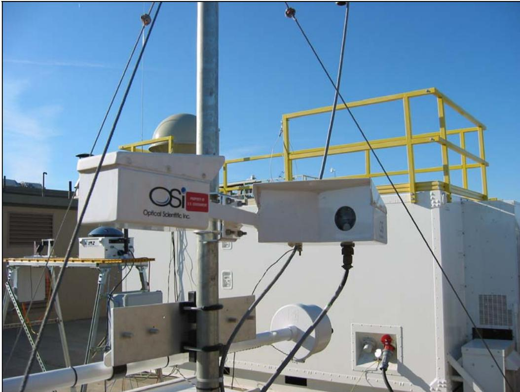
ORG 安装在气象测量塔上，测量降雨率（毫米/小时）。它从其一端向另一端的探测器发出不可见光束。降雨时，雨点打断光束。根据光束被打断的频率来计算降雨率。该仪器可用于计算任何给定时期内的总降雨量。
