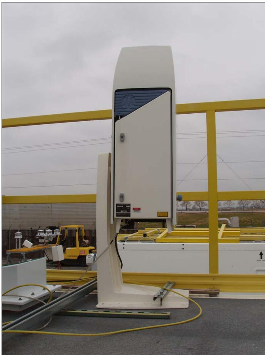
云高计测量地面到直接上空云层底面的距离。该距离称为“云底高度”。云高计可测量地面以上高达约 8 公里 (km) 的云底。云高计发出光脉冲 (闪光)，并测量光在被云底反射后需要多长时间返回。
