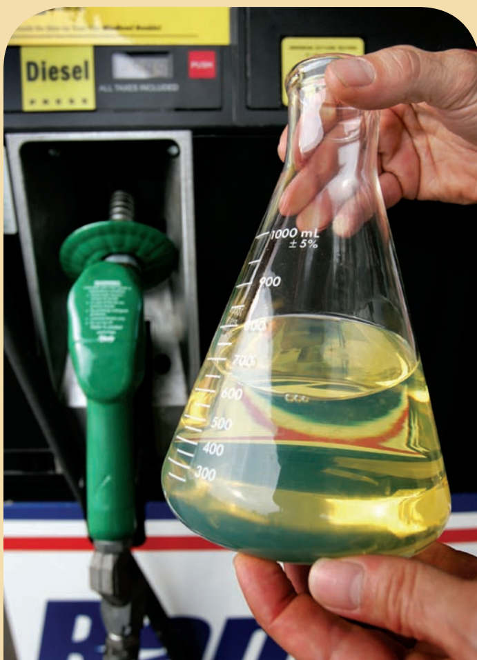
一种更健康的混合：一种包含有20%的生物柴油和80%的标准柴油的B20染料样品。通过植物油的化学转变产生的生物柴油燃烧时比传统的柴油燃料更清洁。
