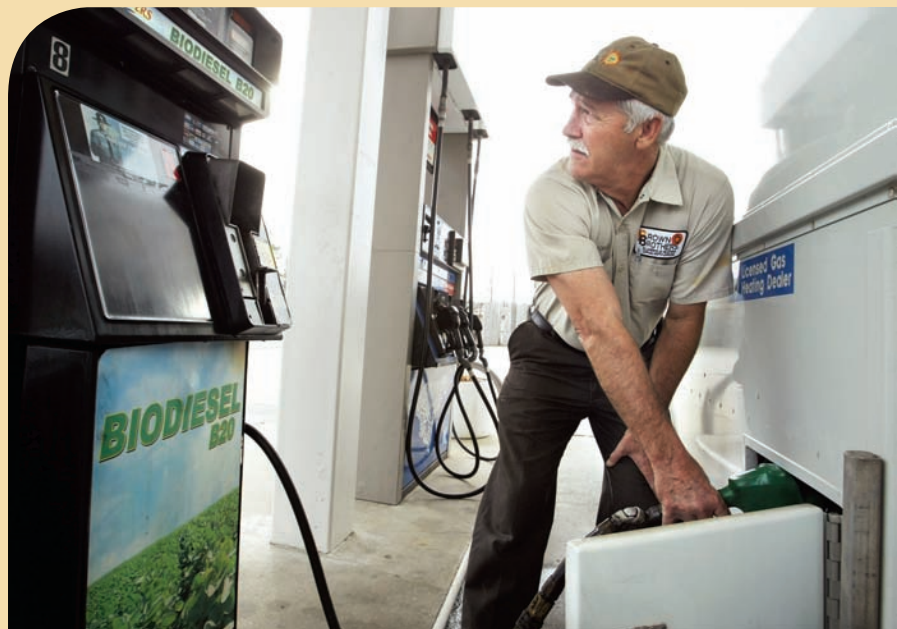
一个新的途径：北卡罗来纳州Durham的一个Exxon加油站，提供一种由石油和大豆、烹饪油和动物脂肪之类的有机原料混合的生物柴油。
