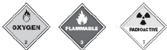
Figura 9.3 – Ejemplos de carteles de materiales peligrosos (HAZMAT)
