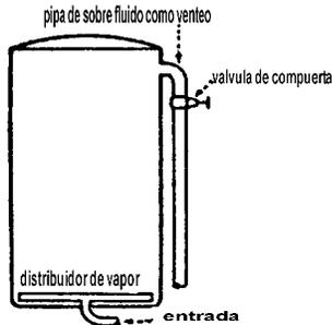
*Especificaciones.* Una tubería de rebalse de 1 1/2 pulgadas equipada con una válvula de compuerta o de grifo de 1 1/2 pulgadas y con una longitud no mayor de 6 pies de tubería de 1 1/2 pulgadas después de la válvula antes de abrir a la atmósfera o hacia un cabezal múltiple.
