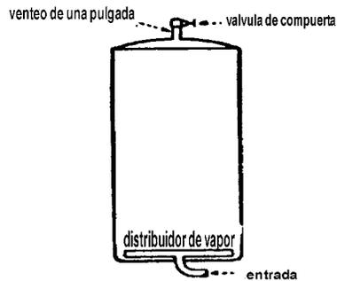
*Especificaciones.* Un venteo de 1 pulgada en la tapa o en la parte superior, equipado con una válvula de compuerta o de grifo de 1 pulgada y descargando directamente a la atmósfera o a un cabezal múltiple.
