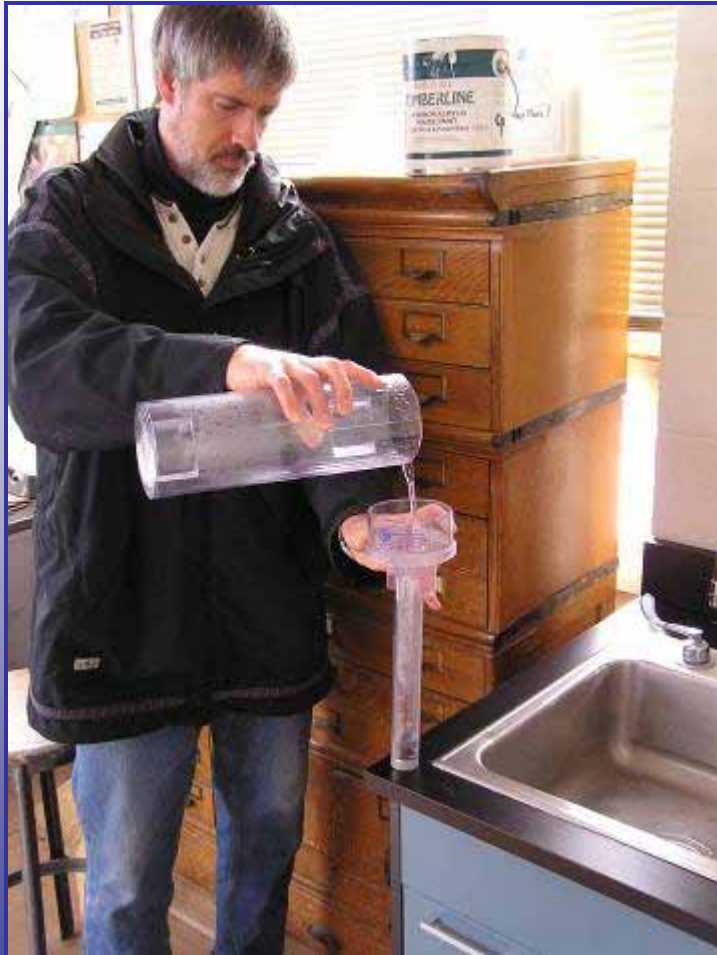
Pour snow sample into smaller tube
