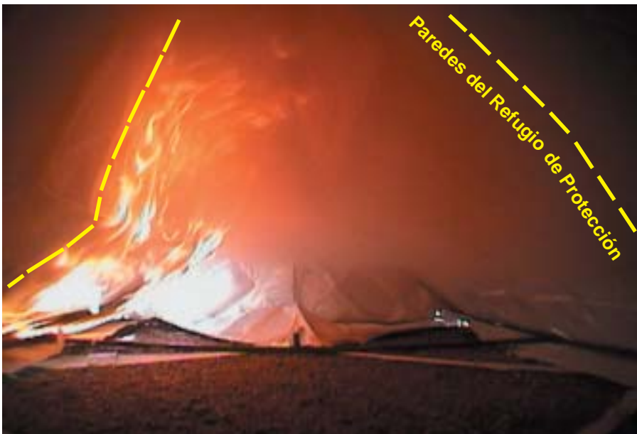
Figura 2—Cuando la llama tiene contacto directo con el refugio de protección, la goma que une el material puede producir gases que pueden encenderse adentro del refugio.
