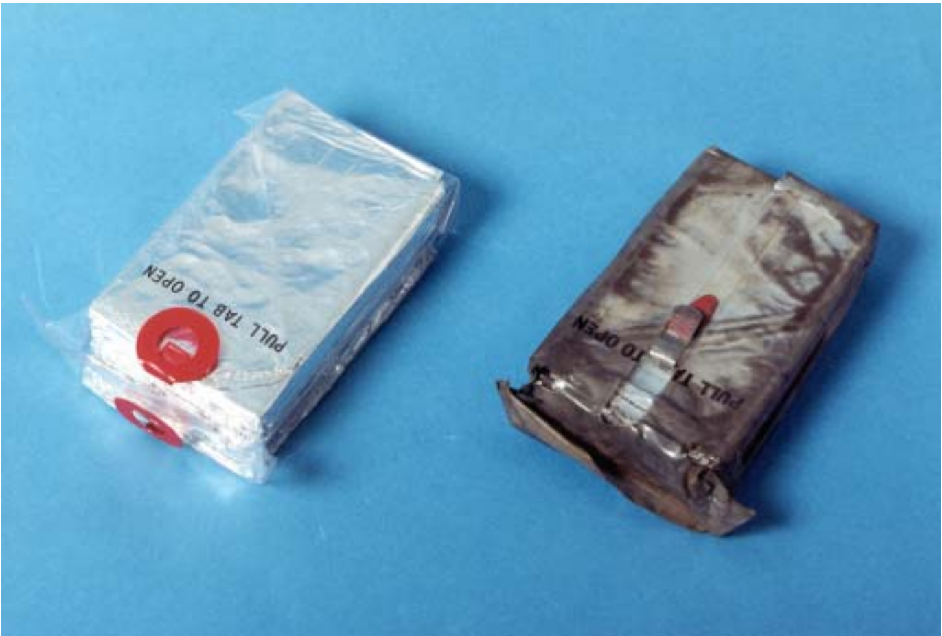
Figura 24—Las inspecciones frecuentes mantienen los refugios dañados fuera de la línea de fuego.
