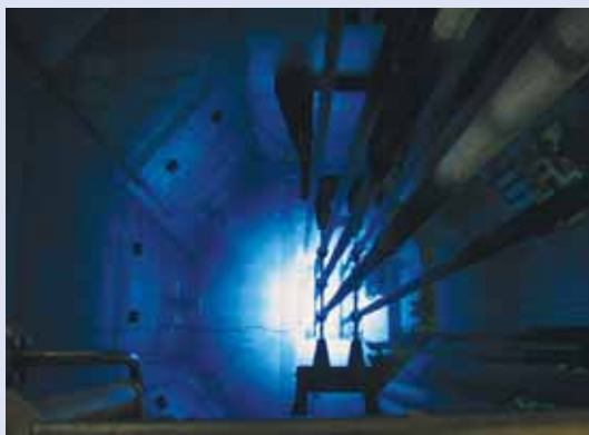
核反应堆核心：图中显示的是一个核反应堆核心部分的俯视图，显示核燃料和控制棒悬挂在水池中。
