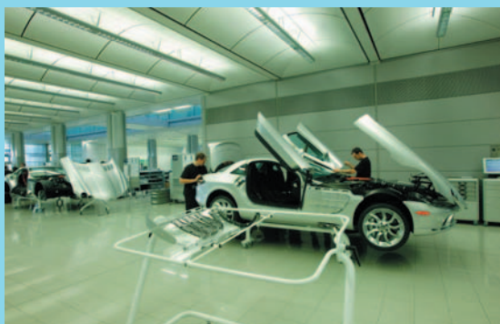
Los compuestos de fibra de carbono se usan para hacer las puertas, el capó y la carrocería del Mercedes-Benz SLR McLaren en una planta en Inglaterra.
