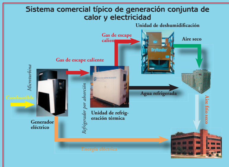
El generador eléctrico con microturbina realiza diferentes funciones energéticas en un edificio.
