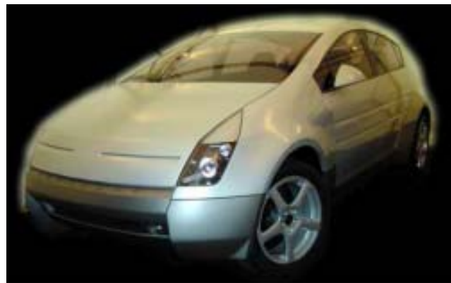
Cuadro 1: Diseño del automóvil The Revolution, un vehículo utilitario deportivo ultraliviano (857 kilogramos), de tamaño mediano y hecho con fibra de carbono, diseñado en 2000.
