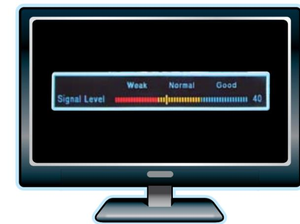
Conforme ajusta la antena, verifique el medidor de intensidad de la señal (como se muestra arriba) para ver qué posición capta las señales más fuertes. La posición óptima de la antena puede variar para canales diferentes.
