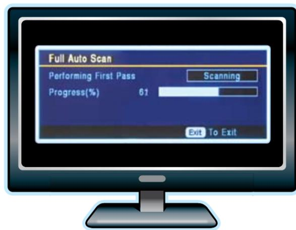
Quando realice un escaneo de canales digitales (mostrado aquí), el sintonizador en su caja convertidora o DTV detectará los canales que capta la antena. Es posible que no obtenga todos los canales en el primer escaneo. Ajuste la antena y repita la acción.
