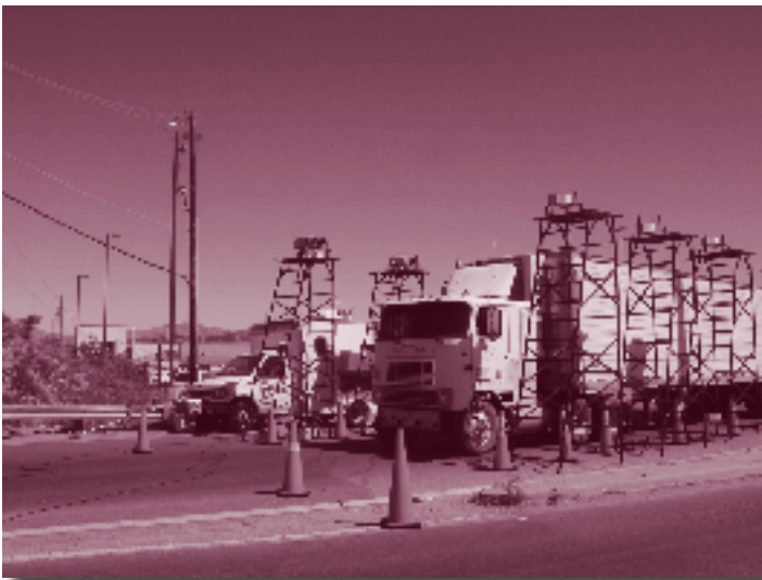
Las tecnologías más avanzadas están siendo desarrolladas para medir las emisiones en los camiones. Estas tecnologías incluyen unidades de sensor remoto de trabajo pesado, sistemas portátiles de monitoreo para emisiones, y opacímetros tradicionales. Esta foto fue tomada en marzo del 2005, cuando el Departamento de Calidad del Medioambiente de Arizona, patrocinó un estudio de Environmental Systems Products basado en Tucson en el Puerto de Entrada de Mariposa en Nogales para probar ese equipo. (Origen: Environmental Systems Products)
