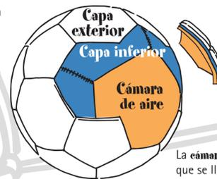
La **cámara de aire** es la parte interior del balón que se llena de aire y normalmente se fabrica de goma de látex natural o butilo (plástico).
