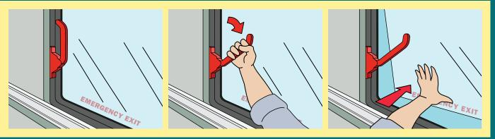
Hay determinadas ventanas designadas como salidas de emergencia que se abren empujando hacia afuera. Para destrabar la palanca y abrir estas ventanas siga las instrucciones marcadas en las mismas.
