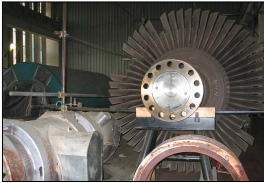
وحدة محرك الضغط الواطئ رقم 5 المتضررة في مشروع الدورة. الصورة: USAID
