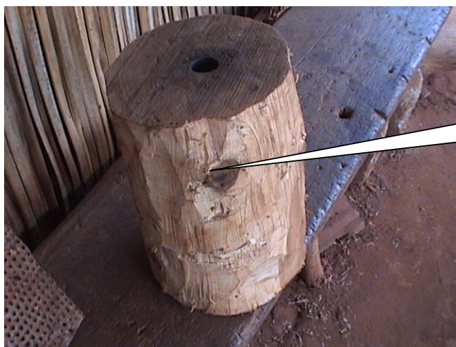
Rotor de râpeuse sculpté en cours de finition
