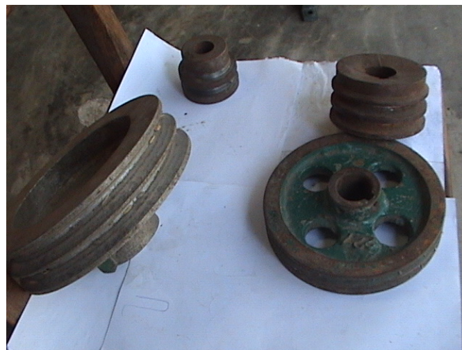
Exemple de poulies de différents diamètres fabriquées en acier doux,
