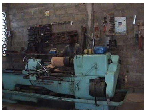
Le tour (Rotor au tournage)
