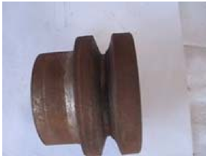
Exemple de poulies de différents diamètres fabriquées en acier doux,
